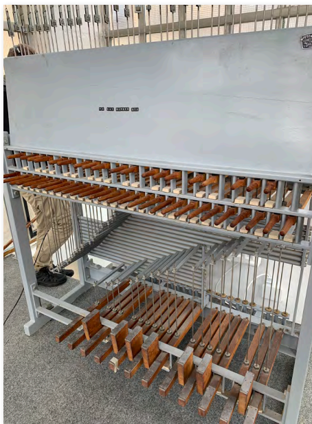
Fig. 16. Stockklaviaturen till klockspelet, som även är utrustat med pedaler. Stockklaviaturen är placerad på våning 4 och kopplad till klockspelet. – Foto: Inger Lindstedt.
